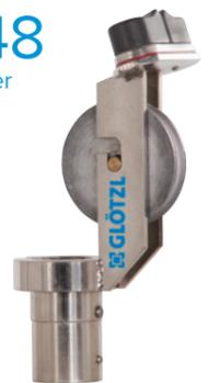
Führungsadapter für 2" Nutrohr mit Umlenk-rolle und Kabelklemme zur Fixierung der Messsonde auf Tiefenlage; Adapter für andere Nutrohrtypen optional.
