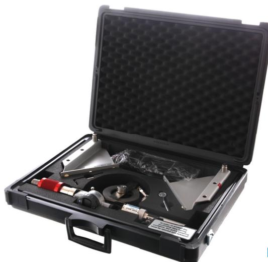
Abb.: Konvergenzmessgerät mit Maßband und digitaler Messuhr, Testrahmen und Montagewerkzeug im Transportkoffer
