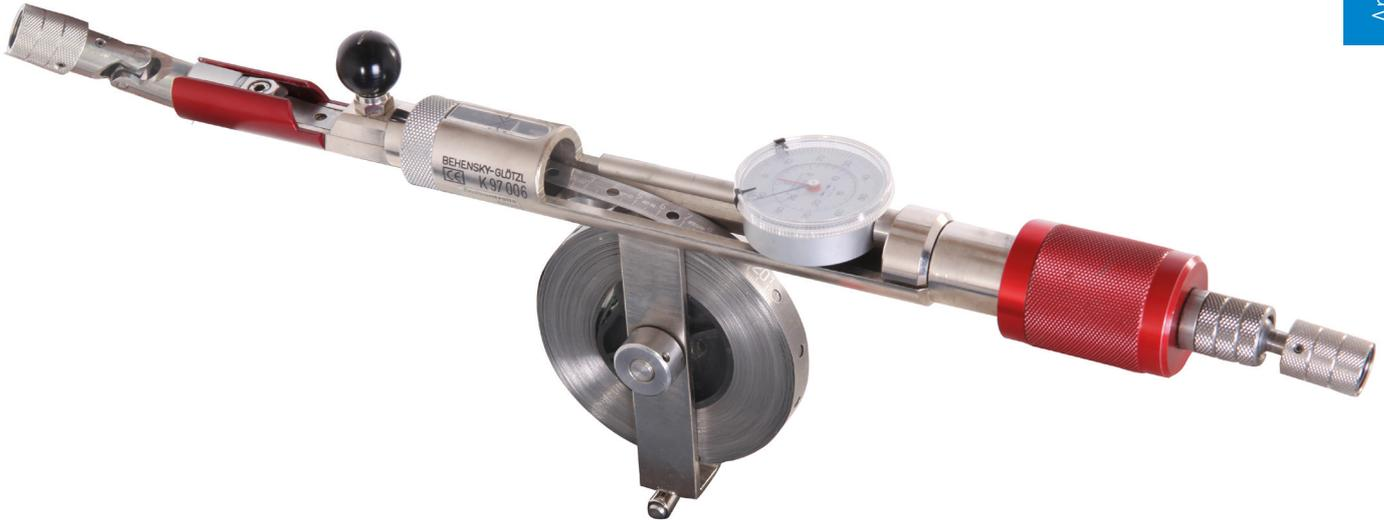
Das BGKM dient der Erfassung von Längenänderungen bei Verschiebungen und Deformationen und ist wahlweise mit einer analogen oder digitalen Messuhr ausgerüstet. Es findet hauptsächlich Anwendung bei Tunneln, Gebäuden und Baugruben. Am Bauwerk werden spezielle Messbolzen angebracht, an denen das Präzisionsmessgerät befestigt wird. Je nach Messaufgabe steht eine Reihe Messbolzen in unterschiedlichen Ausführungen zur Verfügung.
