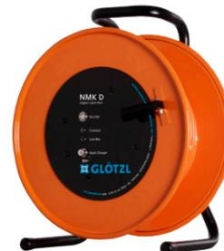
Die digitale Kabeltrommel dient zur Messung der GLÖTZL-Sonden; die Signalübertragung erfolgt über eine Bluetooth-Schnittstelle in Verbindung mit einem Laptop oder Tablet und GLM-Messprogramm.
