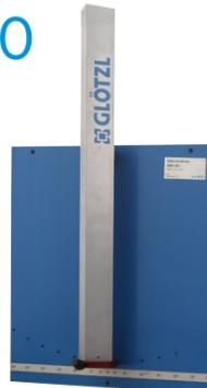
Der Prüfrahmen ER W 30 erlaubt es dem Anwender, den Nullpunkt und den Messbereich seiner Inklinometersonden zu kontrollieren; eine Nachkalibrierung kann jedoch nur im Werk erfolgen.
