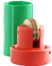
Die Umlenkrolle wird für den Ausbau von horizontalen Inklinometermessstellen verwendet; dank der Umlenkrolle kann ein Zugseil im Messpegel zur Sondenpositionierung eingesetzt werden.
