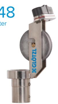
Führungsadapter für 2" Nutrohr mit Umlenk-rolle und Kabelklemme zur Fixierung der Messsonde auf Tiefenlage; Adapter für andere Nutrohrtypen optional.
