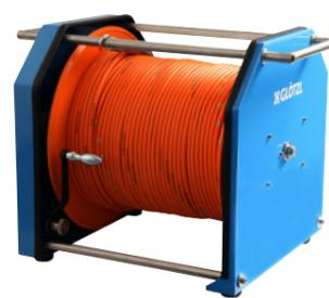
Die schwere Kabeltrommel fasst bis zu 500 m Messkabel; für vertikale und horizontale Neigungsmesssonden; hochdichter Sondenstecker für große Messsteufen; Signalübertragung mittels Schleifringen in Verbindung mit NMA9.
