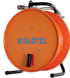
Die leichte Kabeltrommel fasst bis zu 100/150 m Messkabel; für vertikale und horizontale Neigungsmesssonden; hochdichter Sondenstecker für große Messsteufen; Signalübertragung mittels Schleifringen in Verbindung mit NMA9.
