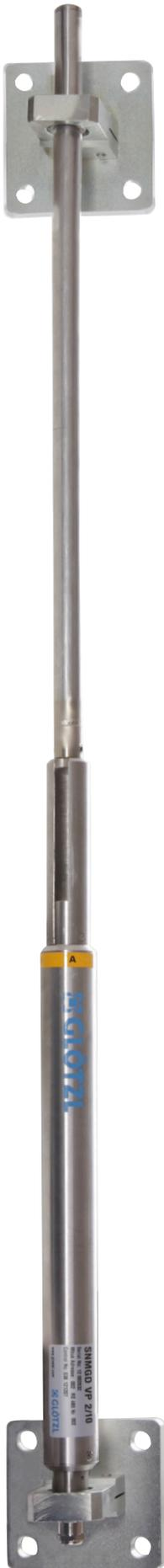
Das BGN dient zur hochgenauen Messung von Neigungsänderungen an einem Gebäude. Es besteht aus einer Basissonde mit entsprechend nach Kundenwunsch ausgeführte mechanisch steifen Gestänge-Verlängerung mit bis zu 5 m Länge. Diese wird über zwei Halteplatten in einer Kugelkalotte spielfrei geführt und gehalten. Die Kugelkalotte erlaubt einen Ausgleich der Halteplatte über eine nicht ebene Gebäudeoberfläche.
