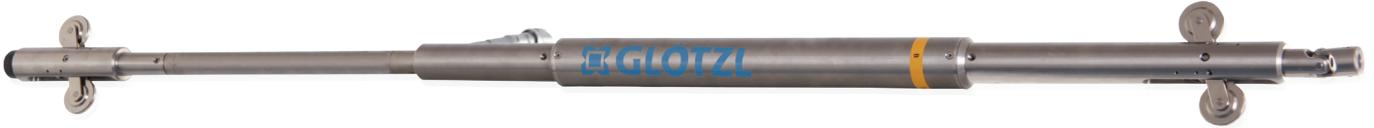
Das stationäre Neigungsmessgerät SNMG ist eine aus mehreren Inklinometersonden gebildete digitale Messkette. Die mechanische Ankopplung der einzelnen Sonden erfolgt durch kardanische Gelenke und Gestänge aus Edelstahl. Durch gefederte Radwippen wird die Messkette in Inklinometermessstellen zentriert installiert.
