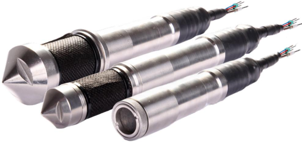
Die Aufnehmer PW3 SV, PW3 RV und PW4 RV bezeichnen Sensoren zur Wasserdruckmessung mit Stirn- oder Ringfilter aus Geotextilvlies. Sie werden im Regelfall zur Grundwasserstands- aber auch zur Porenwasserdruckmessung eingesetzt. Insbesondere in Böden mit schwebstoffreichen oder aggressivem Wasser sind Vliesfilter dauerhaft waserdurchlässig und gewährleisten den Monitoringbetrieb.
