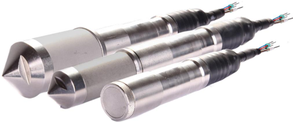
Die Aufnehmer PP3 SS, PP3 RS und PP4 RS bezeichnen Porenwasserdruckaufnehmer mit Stirn- oder Ringfilter aus Sintermetall. Sie werden zur Messung des Grundwasserstands, des Gebirgs- oder Porenwasserdrucks in allen Disziplinen der Bauindustrie eingesetzt. Bei anspruchsvollen Messaufgaben eignen sich insbesondere Aufnehmer mit Ringfilter, die über ihre große Filterfläche einen optimierten Kontakt zum wassergesättigten Boden gewährleisten.
