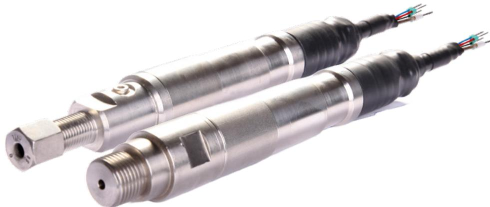
Die Aufnehmerserie PF-3 bezeichnet Sensoren zur Messung von Flüssigkeitsdrücken. Sie lassen sich über das stirnseitige Gewinde an eine Armatur anschließen und stellen so Kontakt zwischen der Sensormembran und dem zu messenden Fluiddruck her. Die Standardversionen bieten wahlweise ein 1/2"- oder ein Ermeto-6S-Gewinde. Auf Wunsch können auch Sonderanpassungen und andere Gewinde ausgeführt werden.
