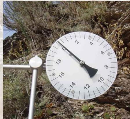
Die Montage erfolgt auf einfachste Weise mittels Dübel auf der Felsböschung. Das Gestänge des Messgerätes kann in allen erdenklichen Richtungen räumlich den Gegebenheiten angepasst und eingestellt werden.
