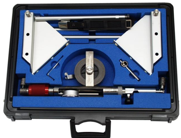
Abbildung: Konvergenzmessgerät mit Maßband und Messuhr, Teststrahlen und Montagewerkzeug im Transportkoffer
