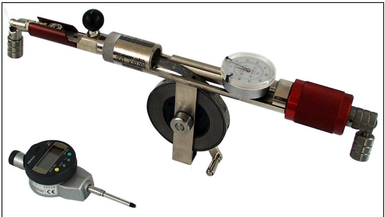
Abbildung: Konvergenzmessgerät ausgerüstet mit mechanischer Messuhr; digitale Messuhr links davon.
