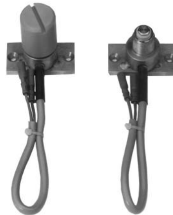
Abb.: Bolzen für Stromversorgung mit Schutzkappe, Typ GKE 40 , mit 200 mm Anschlusskabel, Bau- höhe mit Schutzkappe 60 mm.
