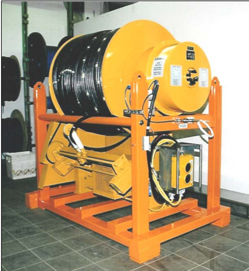
Abb.: Kabeltrommel der Permeabilitäts-Messanlage
