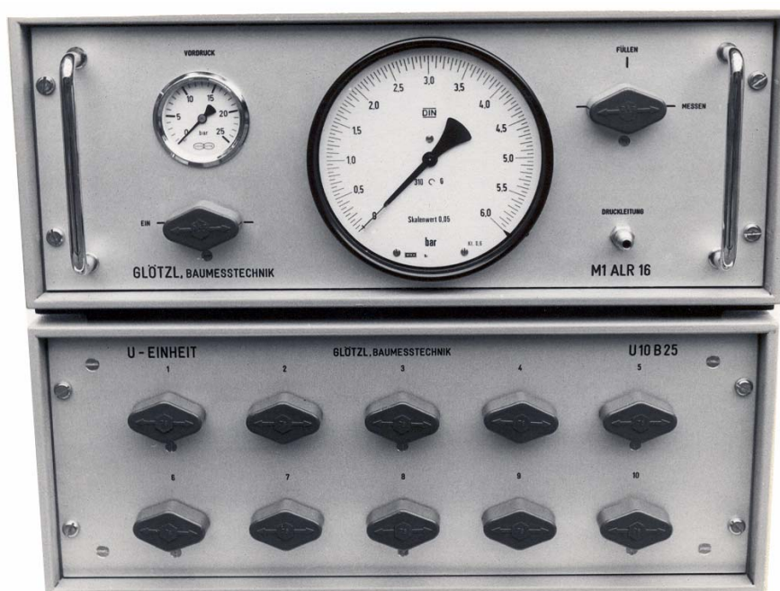
Abbildung: Umschaltgruppe U 10 im Gehäuse 4 HE mit aufgesetz- tem Luftmengenregler M1 ALR 16
