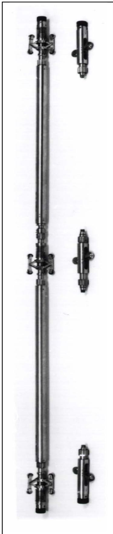
La sonda modular multifunción BMS... está concebida para la medición altamente precisa en dos ejes en tuberías o sondeos verticales y horizontales.
