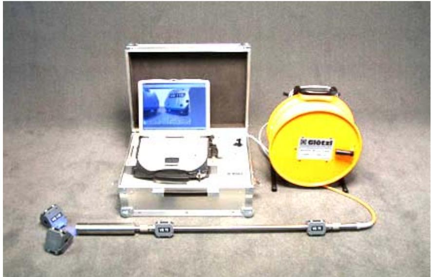
**Abbildung 3** zeigt ein autarkes Videomesssystem mit Videosonde, Führungsadapter, Kabeltrommel und Erfassungseinheit mit Notebook. Die Führungsteile sind austauschbar und können somit an den Bohrl Lochdurchmesser angepasst werden.
