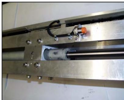
Abb.: Näherungsschalter, Lagerung des Hydraulikzylinder
