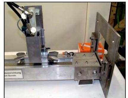
Abb.: bewegliche Schubeinheit und Befestigungsflansch für Bohrlochmund
