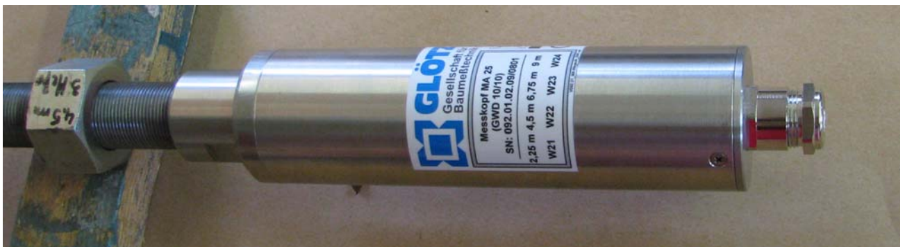
Bild 3: Messkopf mit Fernablesung fertig montiert
