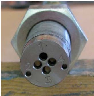
Bild 1: Standardmesskopf MA25 für die Messung mit einer Messuhr
