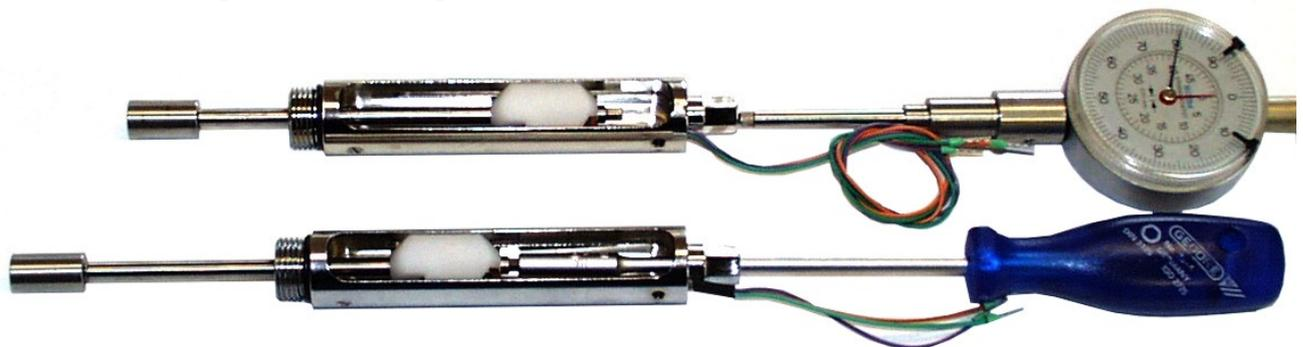
Abb.: Wegaufnehmer Typ: GWO 22/60 mit Messuhr und Steckschlüssel
