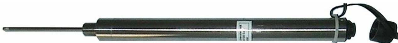
Abb.: Wegaufnehmer Typ GWW 100 Ex für Stangenextensometer
