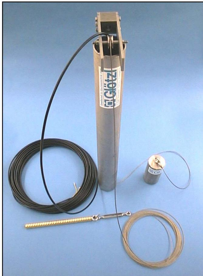
Ein Edelstahl Draht wird zwischen zwei Festpunkten (z. B. einzementierte Bolzen) mit Hilfe eines Spanngewichtes vorgespannt. Die Längen- und Distanzänderungen zwischen den Festpunkten werden über eine Wegmessung am Spanngewicht erfaßt.
