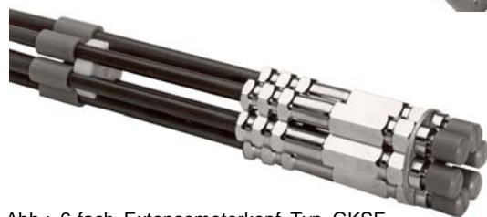
Abb.: 6-fach Extensometerkopf Typ GKSE 6/16, bestehend aus Einfachextensometer mit Montageplatte zum Einbau in Bohrlöcher
