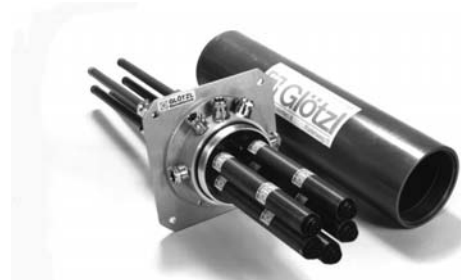
Abb: Kopfplatte mit Wegaufnehmer GWW für Mehrfach-Extensometer mit Schutzrohrabdeckung Ø 126 mm, Länge = 53 mm (bis 5fach Extensometer)
