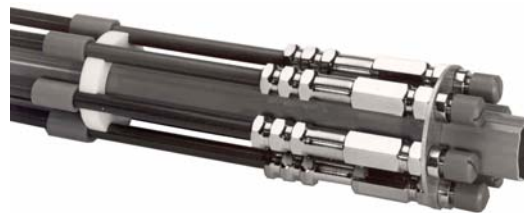
Abb.: 6-fach Extensometerkopf Typ GKSE 6/16, bestehend aus Neigungsmessrohr mit 6 Einfachextensometer, versenkbarer Montageplatte zum Einbau in Bohrlöchern. Zur Fixierung der Extensometer um das Neigungsmessrohr sind entsprechende Halterungen aus Kunststoff lieferbar.
