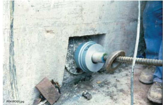
Abb.: Ankerkraftgeber, auf Ankerplatte aufgelegt, vor dem Spannen des Ankers
