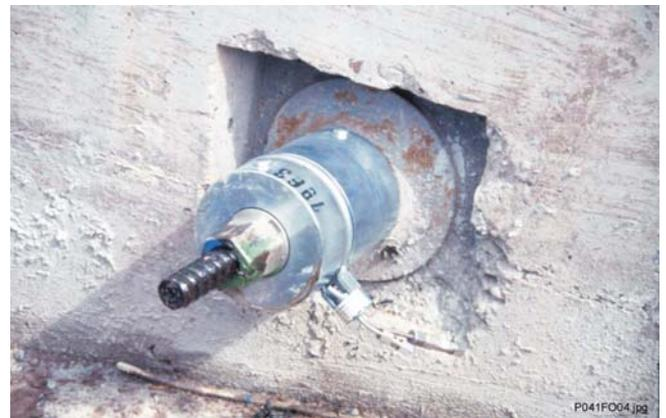
Abb.: Festgelegter Anker mit Ankerkraftmessdose
