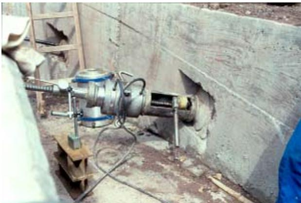
Abb.: Ankerkraftgeber mit Spannvorrichtung
