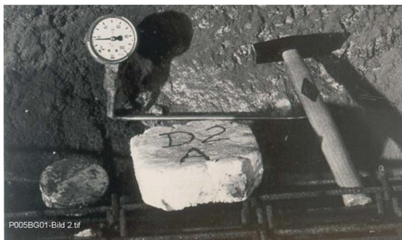
Betonspannungsaufnehmer eingebaut im Tunnel in Spritzbeton.
