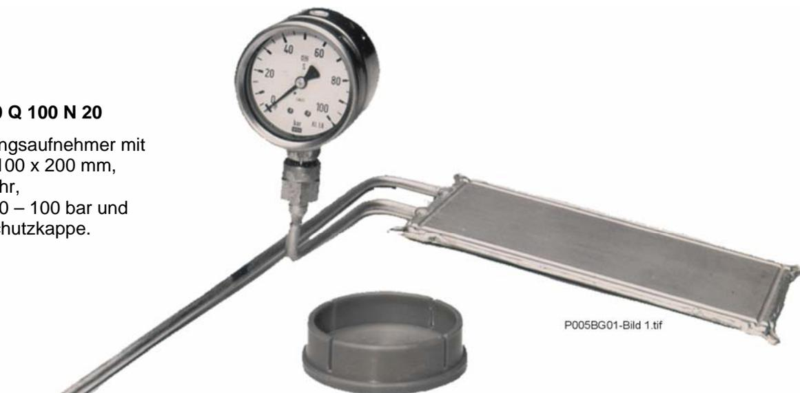
Zur Befestigung an der Bewehrung ist das Druckkissen an den Enden mit Befestigungsösen versehen.
